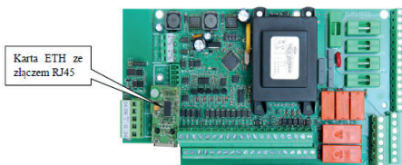
Rys. Nr 26 Karta Ethernet i sposób jej montażu.
